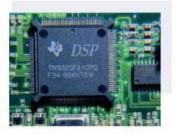
В основной цепи применен **высокоскоростной DSP**
