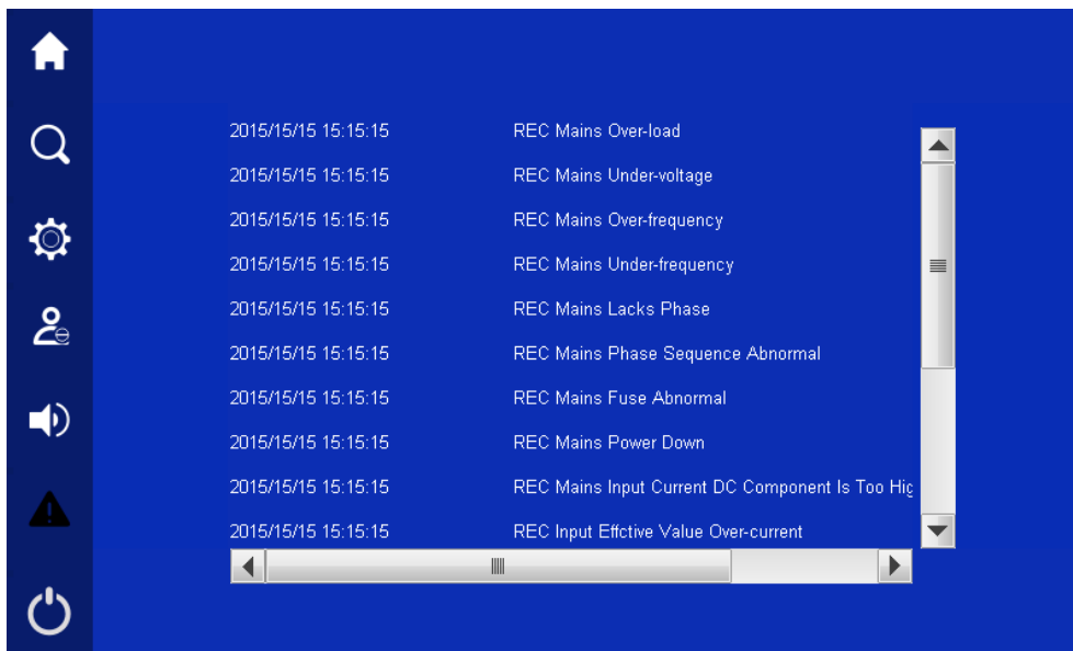
Рис. 4.15 Текущие неисправности ИБП
