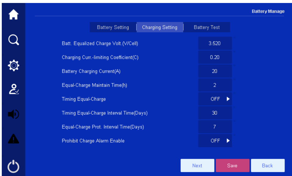
Рис. 4.33 Вкладка Настройки заряда 1
