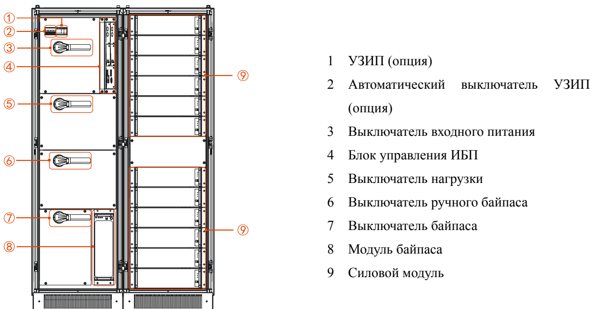
Рис. 2.7 Структурное расположение основных элементов MR33400, MR33500, MR33600, (передняя дверь ИБП открыта)
